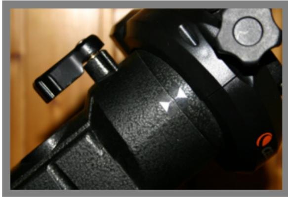
FIGURE – Index de déclinaison sur la monture.
