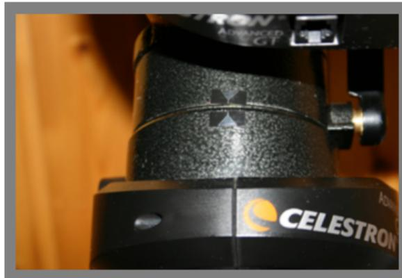
**FIGURE** – Index d'ascension droite sur la monture.
