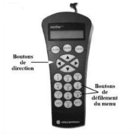
**FIGURE** – La raquette du GOTO. Source : Manuel nexstar
